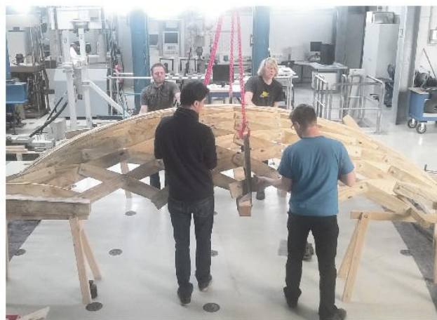
Nachbau eines Zollingerdaches in der HTWK-Werkstatt Foto: privat
